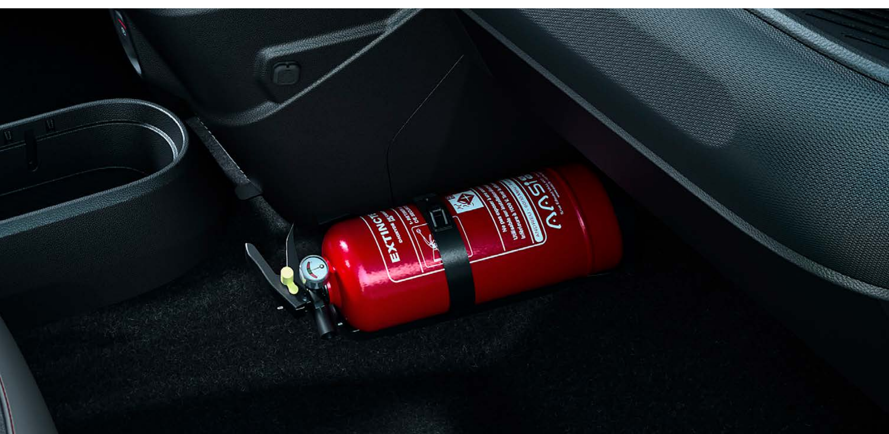
remen za pričvršćivanje aparata za gašenje požara i aparat za gašenje požara od jednog kilograma
