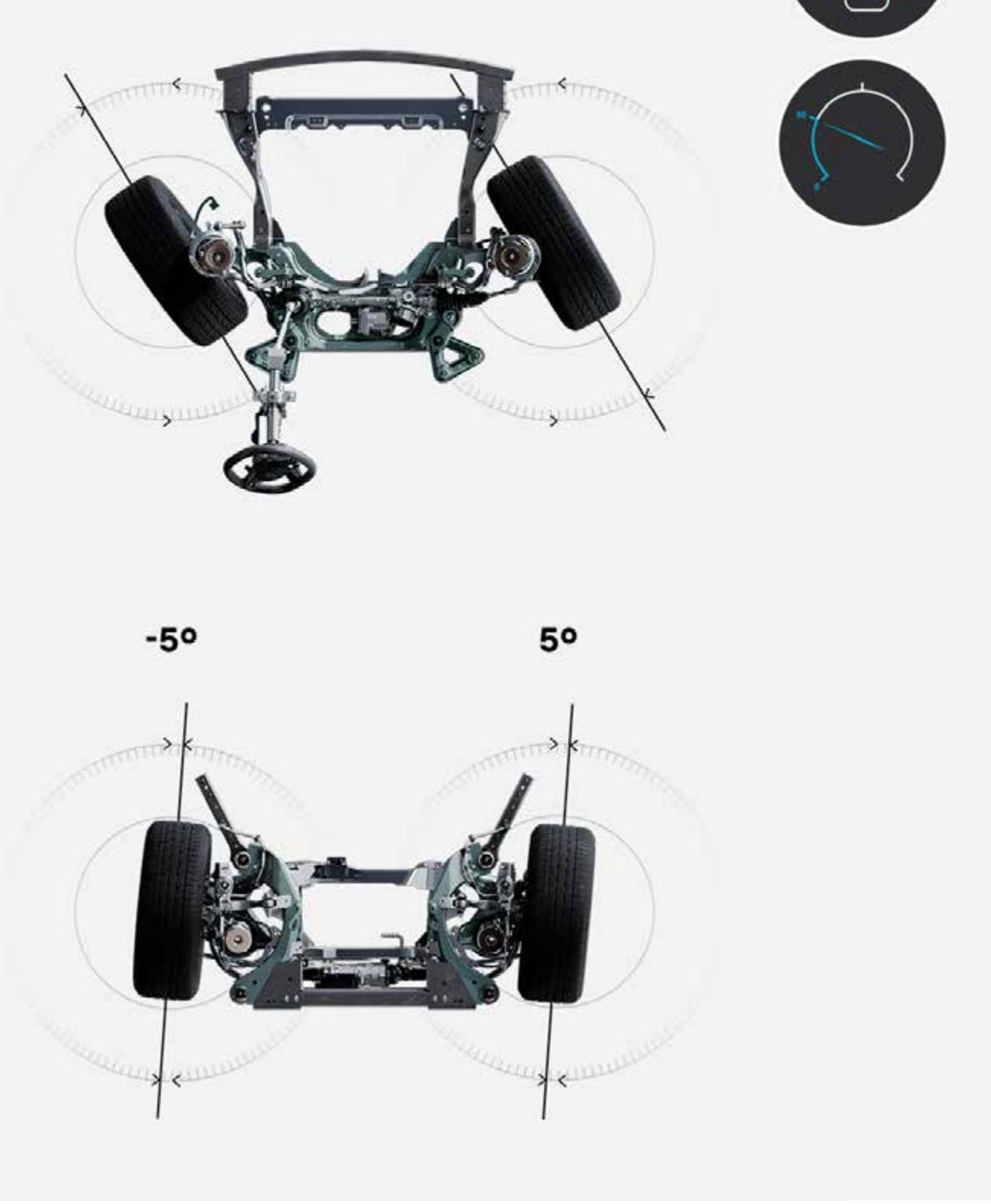
pri brzinama do 50 km/h, stražnji se kotači okreću u suprotnom smjeru od smjera prednjih kotača kako bi se smanjio krug okretanja i olakšalo manevriranje.
