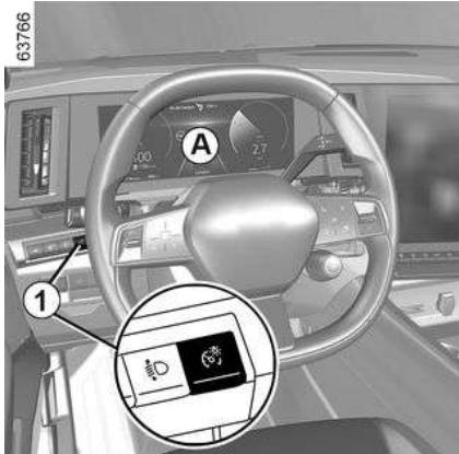
**Instrumentna ploča A:** ovo se osvjetljava kad se otvore vrata vozača. Pritisnite prekidač **1** onoliko puta koliko je potrebno da prilagodite svjetlinu.
