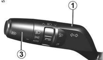
Ova vam funkcija omogućuje trenutno paljenje pozicijskih i kratkih svjetala (npr. za osvjetljenje prilikom otvaranja vrata).
