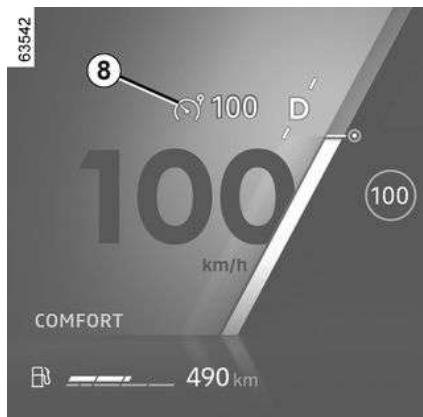
Kontrolno svjetlo 8 prikazuje se u sivoj boji. Poruka "Ograničivač brzine" spremište: POSTAVI na uključeno" prikazuje se na instrumentnoj ploči popraćena crticama, kako bi se označilo da je funkcija ograničivača brzine uključena i da čeka na pohranjivanje brzine ograničenja.
