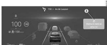
Kada je otkriveni objekt vrlo blizu, oglasit će se zvučni signal i bit će popraćen porukom upozorenja **3** "Otkrivena prepreka sa strane vozila" na instrumentnoj ploči.
