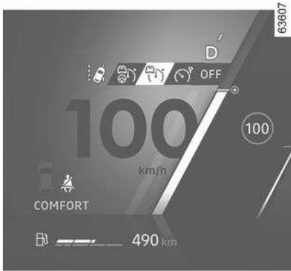
Pritisnite prekidač **3** onoliko puta koliko je potrebno za odabir prilagodljivog regulatora brzine. Kontrolno svjetlo **10** prikazuje se u sivoj boji. Na instrumentnoj ploči prikazuje se poruka "Adaptivni regul. brzine spremjan: SET za aktivaciju" popraćena crticama, što ukazuje na uključenu funkciju regulatora brzine koja čeka na pohranjivanje putne brzine.
