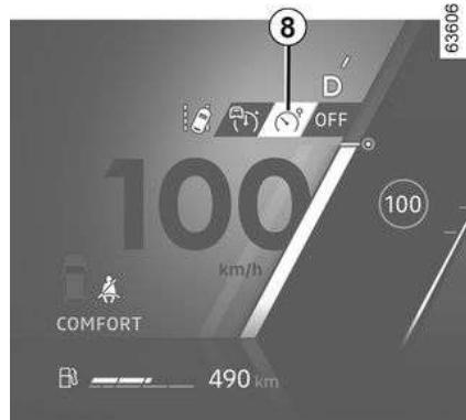
Kontrolno svjetlo **8** prikazuje se u sivoj boji. Na instrumentnoj ploči prikazuje se poruka "Regul. brzine OK SET za aktivac." popraćena crticama, što ukazuje na uključenu funkciju regulatora brzine koja čeka na pohranjivanje putne brzine.
