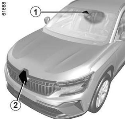
Na temelju informacija koje prenosi kamera **1**, funkcija pokreće korektivnu radnju na sustavu upravljanja vozila prilikom približavanja rubu ceste (pregradi, prepreči, pločniku, nasipu itd.) bez uključenog pokazivača smjera.
