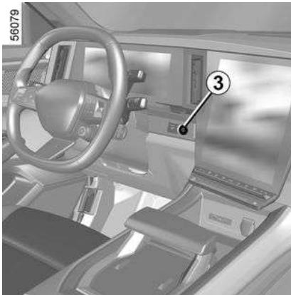
Ako pametni telefon više nije u putničkom prostoru kada želite isključiti motor, na instrumentnoj ploči prikazuje se poruka: pritisnite i držite gumb za pokretanje/zaustavljanje motora **3** dulje od dvije sekunde.
