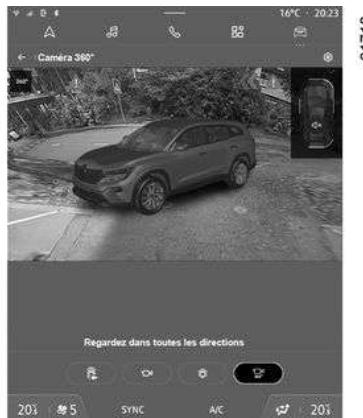
Na multimedijalnom zaslonu pritisnite namjenski gumb **11** za 3D (trodimenzionalni) prikaz vozila i područja oko njega.
