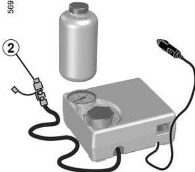
Kada je guma pravilno napuhana, uklonite komplet: polako odvijte nastavak za napuhavanje od spremnika **2** da biste sprječili prolijevanje sredstva, a zatim pohranite spremnik u plastično pakiranje da biste sprječili curenje sredstva.
