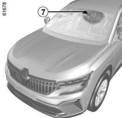
Ovisno o vozilu, prilagodljiva duga svjetla podijeljena su na nekoliko neovisnih okomitih segmenata. Ova funkcija upotrebljava kameru **7** koja se nalazi iza unutarnjeg retrovizora za otkrivanje vozila koja se nalaze ispred te vozila koja dolaze iz suprotnog smjera.
