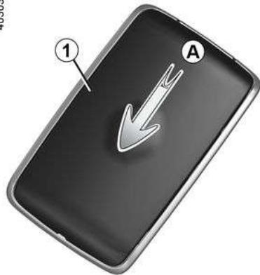
Kada se na instrumentnoj ploči prikaže poruka "Slaba baterija kartice", zamijenite bateriju u kartici:
