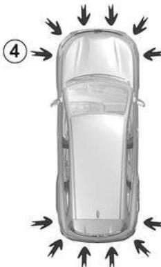
Ova značajka pomaže pri teškom upravljanju (npr. parkiranje) prikazivanjem okruženja vozila koristeći podatke iz kamera 1, 2 i 3 koje se nalaze u oblozi prednjeg branika, vanjskim retrovizorima i na vratima prtljažnika te pomoći ultrazvučnih detektora 4 smještenima u oblogama branika.
