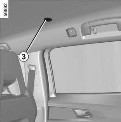
**i** Otključavanje i otvaranje vrata ili prtljažnika dovodi do paljenja vremenski podešenog stropnog svjetla i svjetala.
