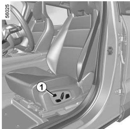
Ovisno o vozilu, na višefunkcijskom zaslonu dostupne su brojne funkcije. Na vozilima koja su njime opremljena prekidač **1** omogućuje izravan pristup izborniku "Sjedala" na multimedijском zaslonu.
