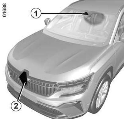
Sustav upotrebljava podatke s radara 2 i kamere 1 radi određivanja udaljenosti između vašeg vozila:
