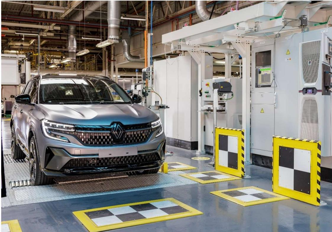
*Jednom kad se novi Austral nađe na testnoj klupi, prilagodba projekcije na vjetrobransko staklo provodi se uz pomoć kamere pričvršćene na zglobnu ruku*
